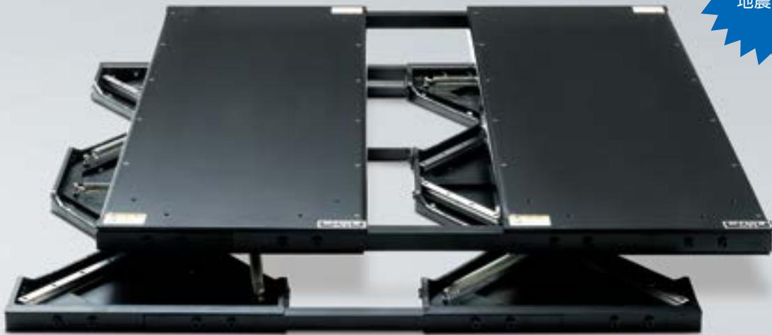
SD-5 typeⅢは水平方向の地震動に対応するラック用免震装置です。常時待機方式でスタート機構がなく短周期地震動に対応するtypeⅡの特長に加え、可動部にトリガー材を取り付けることで長周期地震動による変位制御を実現しました。セパレートタイプでケーブル接続中の機器にも導入可能で、マシンの台数に合わせて連結してご利用いただけます。
