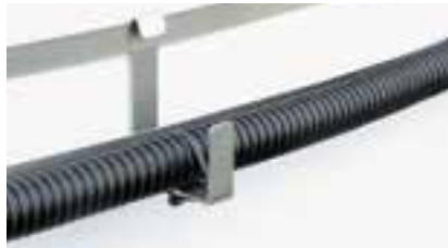
ロゴスキーコイル（風車への設置例）
